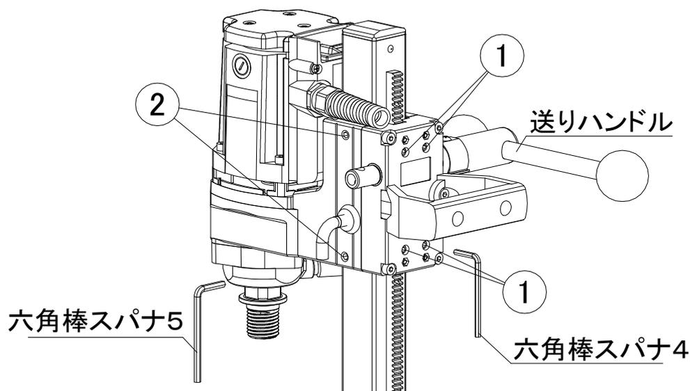
強く締めすぎると送りが重くなり、正確な作業ができません。送りハンドルでスライドブロックを動かしながら少しずつ調整をしてください。強く締めすぎないようにしてください。
