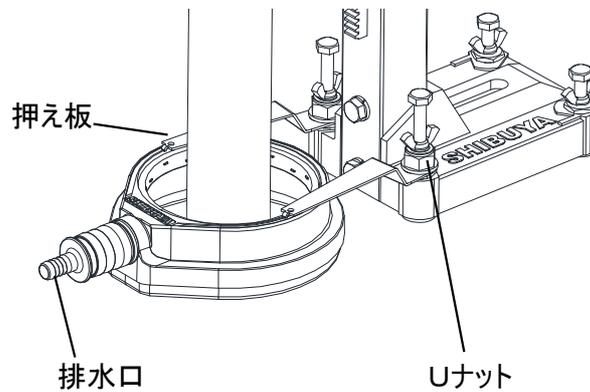
押え金具の調整は、押え板が手で回転するくらいまで、Uナットを締め込んでください。
