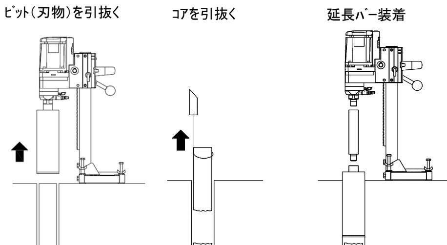
M27ねじの延長バーは、ビット(刃物)径 32mm以下のサイズのビット(刃物)には使用できません。特殊寸法の延長バーも製作いたします。
