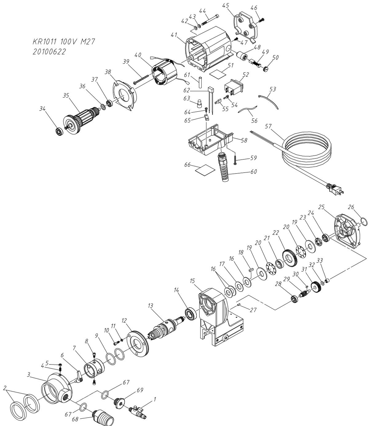
図4-5 モーターユニット KR1011 部品構成図
