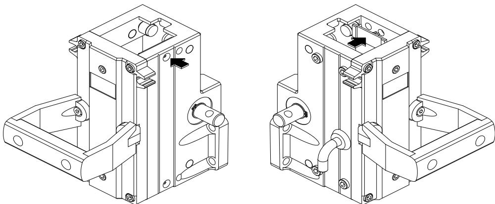
図9.3 スライドプレートの交換
